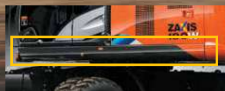
Боковые лонжероны D-образного сечения
