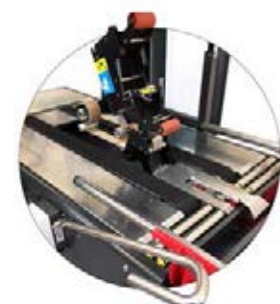
Sistema brevettato per cambio rapido nastro adesivo Patented system for quick change of adhesive tape
