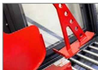
DISPOSITIVO PNEUMATICO CHIUDIFALDE PNEUMATIC FLAP CLOSURE DEVICE
