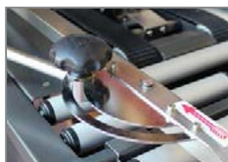
SISTEMA PER LA CENTRATURA DELLA SCATOLA SYSTEM FOR CENTERING THE BOX
